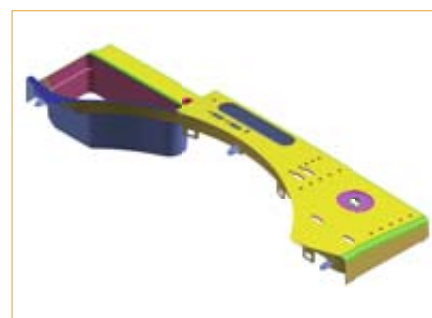
Simulation eines Plattenhalters für ein optisches Präzisionsgerät aus glasfaserverstärktem PBT (Polybutylenterephthalat).
