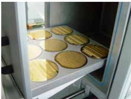
Hohe Produktivität: Blick in die Prozesskammer der Ätzanlage STP 2020, befüllt mit 9 Wafern mit einem Durchmesser von jeweils 150 mm
