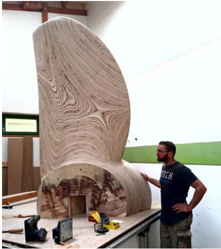
Mehrfach gekrümmtes Bauteil zum Formenbau und Guss einer Schiffsschraube
